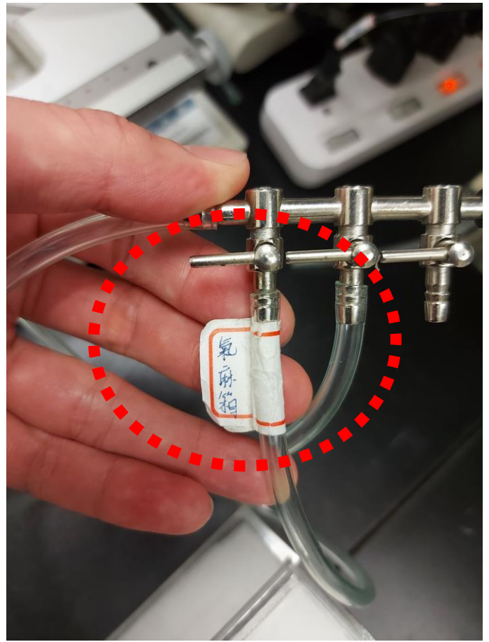
關閉麻醉相閥門
